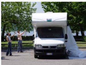
Sistema di montaggio con corde, per issare il telo sul camper facilmente e senza l'uso di scale
