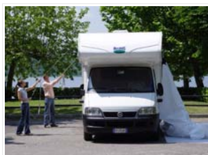
Système de montage avec cordes, pour hisser la housse facilement sur le camper sans besoin d'escalier.
